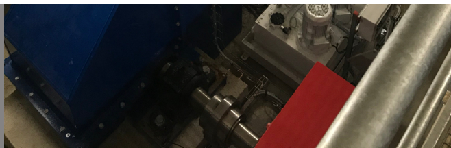
Turbine Pelton horizontale 2 jets de 400 kW en France (Pyrénées-Orientales)
