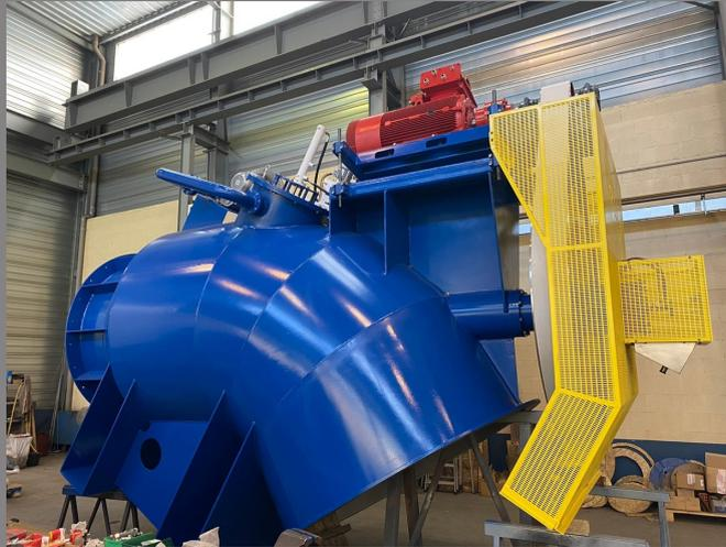
Fabrication terminée dans notre usine HYDREO pour cette belle turbine Kaplan (diamètre 1600 mm), à axe incliné, siphon, simple réglage, destinée à être installée dans une centrale hydroélectrique périgourdine.
